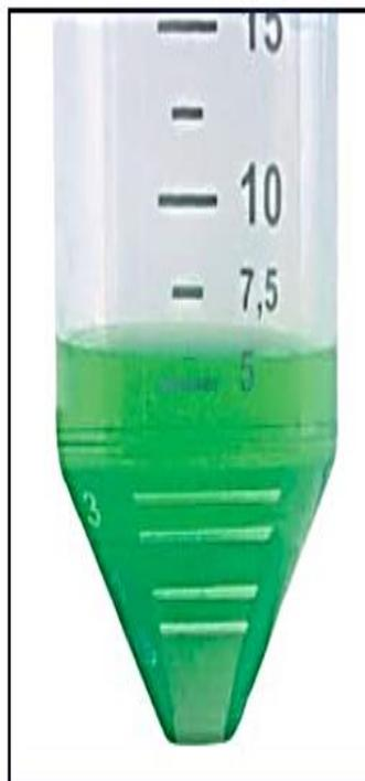
*Las marcas de volumen precisas en el fondo del tubo muestran claramente el volumen de líquido contenido en el fondo.*
